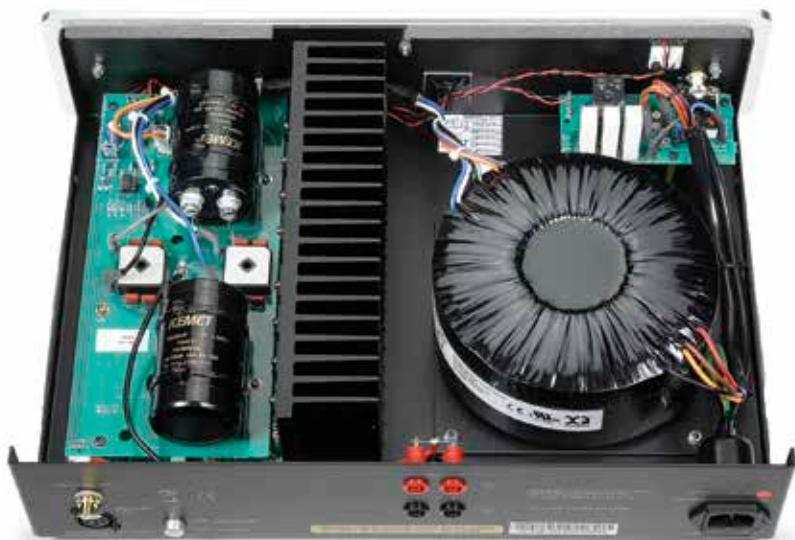
Der Aufbau nutzt den Kühlkörper mit den Leistungstransistoren recht geschickt als Abstandhalter und Schirm gegen den Ringkerntrafo.
