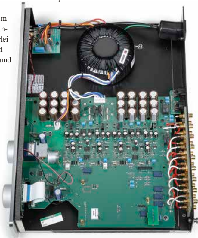
Auch die Signalverarbeitung des Vorverstärkers ist offensichtlich streng in Doppel-Mono ausgeführt, Trafo und Siebung fallen üppig aus.
