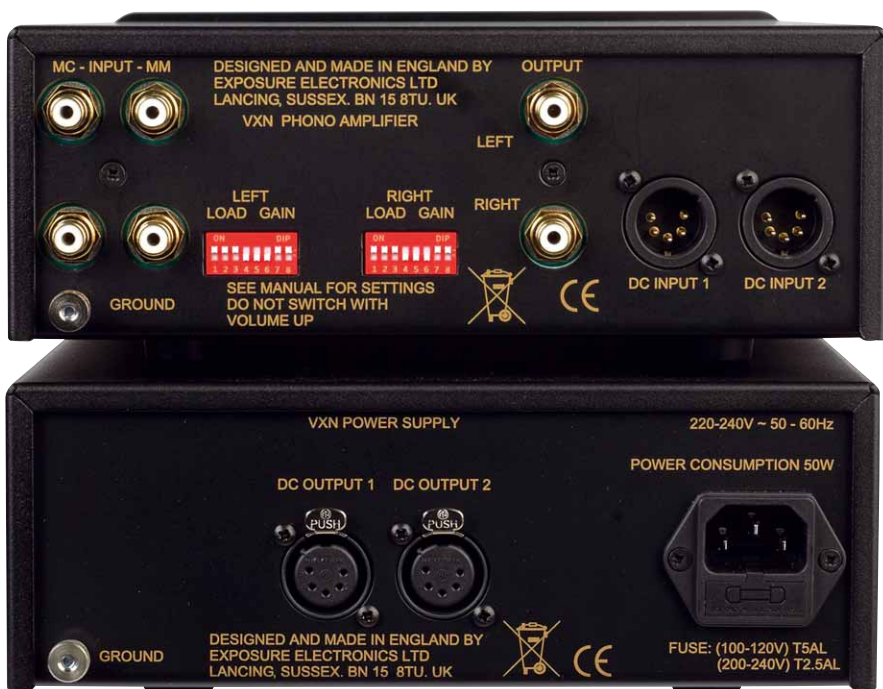
So sieht das Duo von hinten aus: kanalgetrennte Versorgungen und die unvermeidlichen DIP-Schalter
