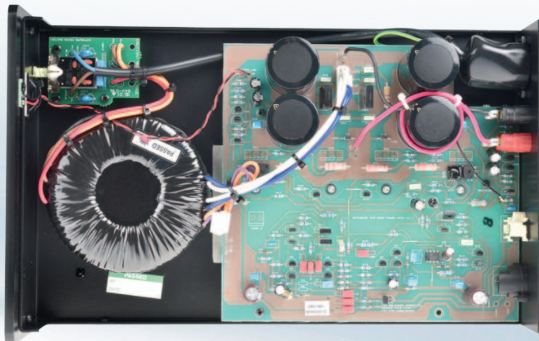
Beim Blick ins Innere fällt auf, dass es hier keinen sichtbaren Kühlkörper gibt. Die Kühlung erfolgt über den Gehäuseboden. Die Transistoren sitzen links bzw. rechts vor den Elkos, dazwischen die „hautfarbenen“ Emitterwiderstände.
