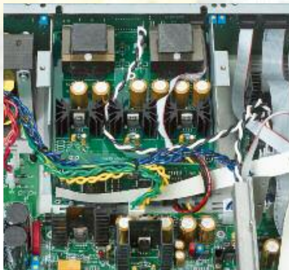
Die extrem aufwändige Netzteilsektion steckt unter einem abschirmenden Blechgehäuse
