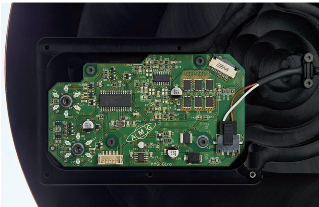
Die Steuerelektronik für den Motor befindet sich in der runden Basisplatte aus Flugzeug-Aluminium
