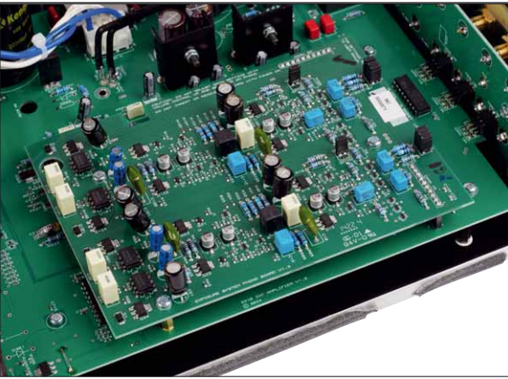
Klassische Exposure Huckepack-Platine. In diesem Fall für Phono MC. Und die ist alles andere als eine Notlösung
