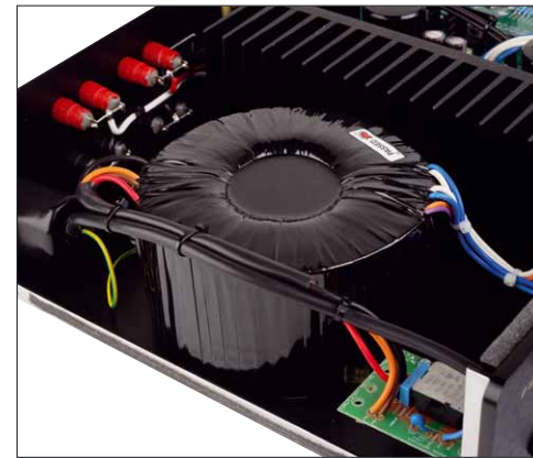
Ohne den geht es bei Exposure nicht: einen reichlich dimensionierten Netztrafo, der immer genügend Leistung zur Verfügung stellt
