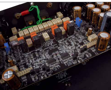
Die Verstärkerschaltung ist diskret in SMD-Technik aufgebaut
