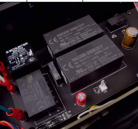
Drei kleine Schaltnetzteile erzeugen die „rohen“ Betriebsspannungen für das Gerät
