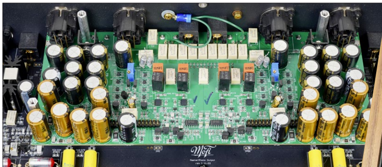
Das Netzteil und die mit eng tolerierten Bauteilen bestückte Elektronik – links die komplexe Platine unter dem Schutzdeckel – sitzen in getrennten Gehäusen. Die Versorgungskabel werden durch kurze Kupferrohre geführt.
