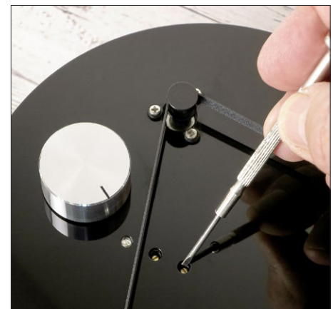
Über zwei Mini-Potis hinter Öffnungen in der Motordose sind die Drehzahlen fein justierbar.
