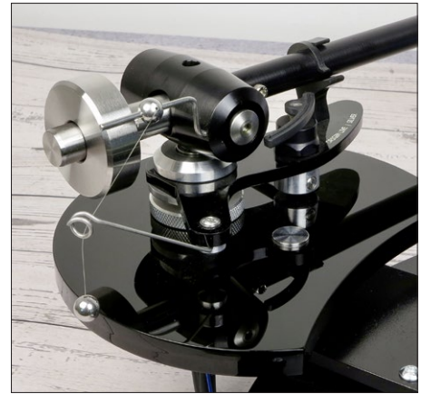
Die Antiskating des in der Höhe verstellbaren Tonarms funktioniert per Faden und Gewicht.
