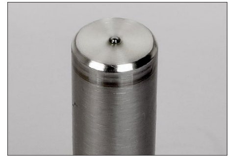
Die auffällig dicke Achse des Plattentellers läuft reibarm auf einer kleinen Stahlkugel.
