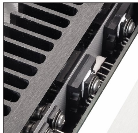
Auf den innen liegenden, kanalgetrennten Kühlkörpern sitzen die Endtransistoren der Dione.
