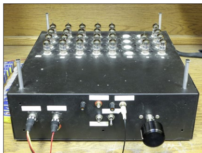
In diesem Gerät durchlaufen Kleinsignalröhren ihre 100-stündige Testphase.
