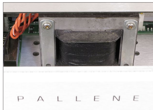
Die unter einer streufelddichten Metallhaube platzierten Trafos stammen aus Eigenfertigung.
